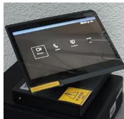
Consola: Dispositivo controlador para videoconferencias, este se vincula a varios componentes del aula.
