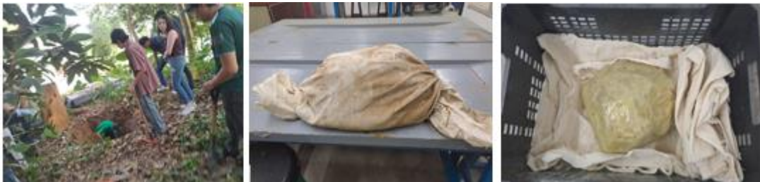
Imagen 59. Extracción de muestra de suelo. Fuente: Archivo Dirección FAUV Xalapa (2024).
