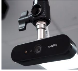
Cámara de contenido: Enfoca la parte frontal del aula en donde se encuentra el pizarrón y el profesor. Permite que el contenido que se escribe en el pizarrón se pueda digitalizar y grabar.
