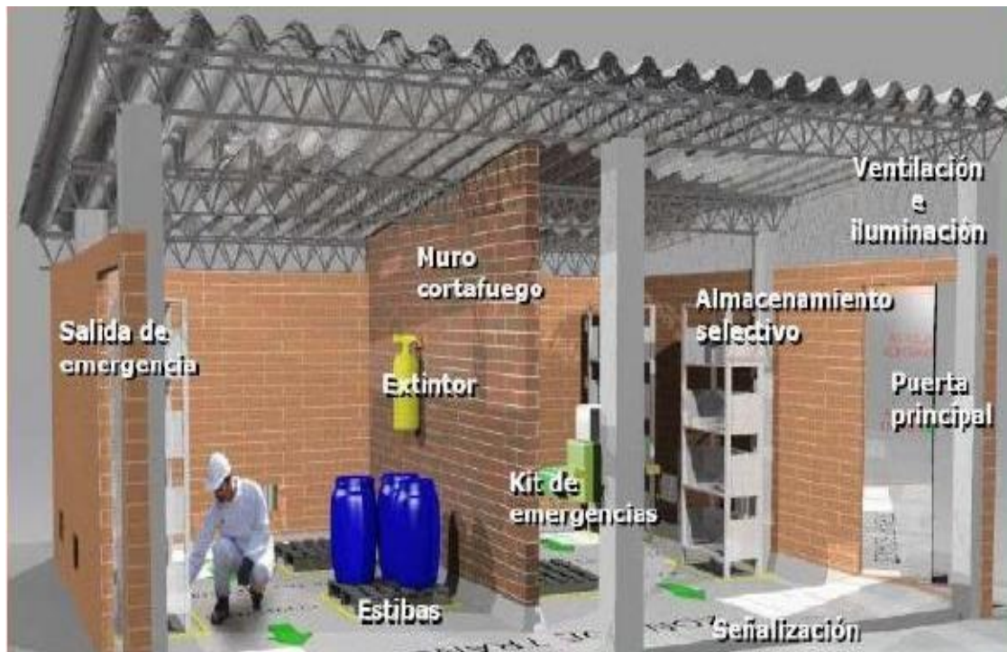
Figura 8 Almacén temporal de Residuos Peligrosos
