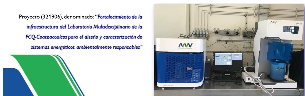
Figura 25. Equipo de análisis de quimisorción automático con estaciones de quimisorción por pulsos y fisorción de nitrógeno (Elaboración propia, 2024).
