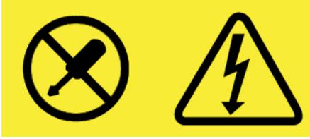
**Dentro de cualquier componente que tenga adherida esta etiqueta hay niveles peligrosos de voltaje, corriente y energía. Estos componentes no poseen piezas que se puedan reparar. Si sospecha de un problema con una de estas partes, póngase en contacto con un técnico de servicio.**
