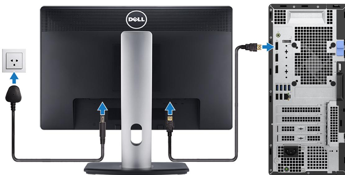
**NOTA:** Si se realizó el pedido del equipo con una tarjeta gráfica discreta, el puerto HDMI y los puertos de visualización en el panel posterior de la computadora estarán cubiertos. Conecte la pantalla al puerto de la tarjeta gráfica discreta.
