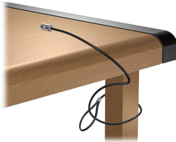
Figura C-3 Acoplado del Cable a un Objeto Fijo
