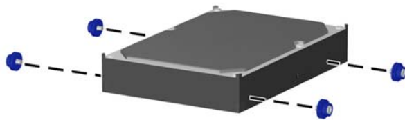
Figura 2-37 Instalación de los Tornillos Guía en la Unidad de Disco Duro
