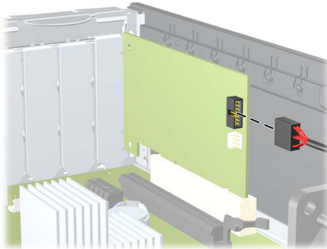
Figura 2-30 Desconexión del Cable 1394 del Lector de Tarjetas de Multimedia
