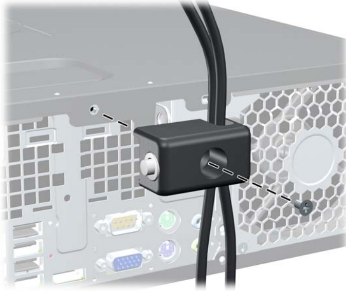
Figura C-5 Acoplado del Bloqueo al Chasis
