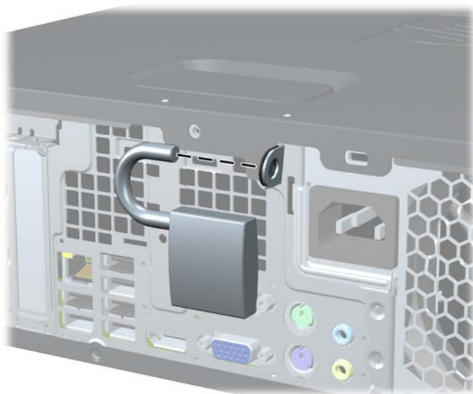
Figura C-2 Instalación de un candado
