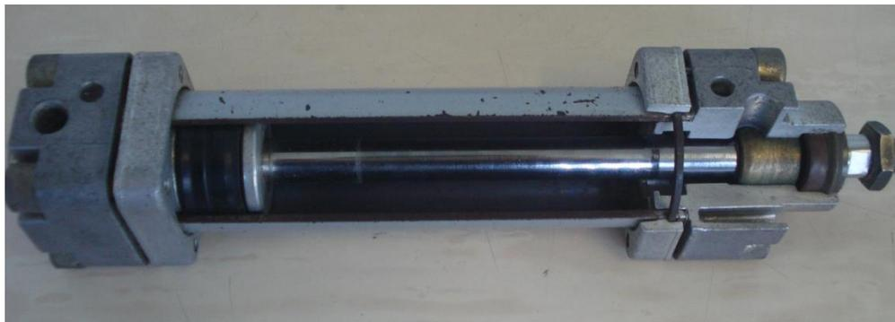
Ilustración 40 Vista interior de un cilindro.
