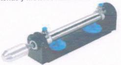
El cilindro de simple efecto funciona cuando se le aplica presión por un solo extremo y este realizara el trabajo en un solo sentido, el cual es sacar el vástago del cilindro y para el regreso cuenta con un muelle en su interior el cual cuando se le deja de aplicar presión regresa o por alguna fuerza externa.
