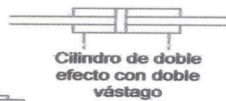
Cilindro de doble efecto con doble vástago
