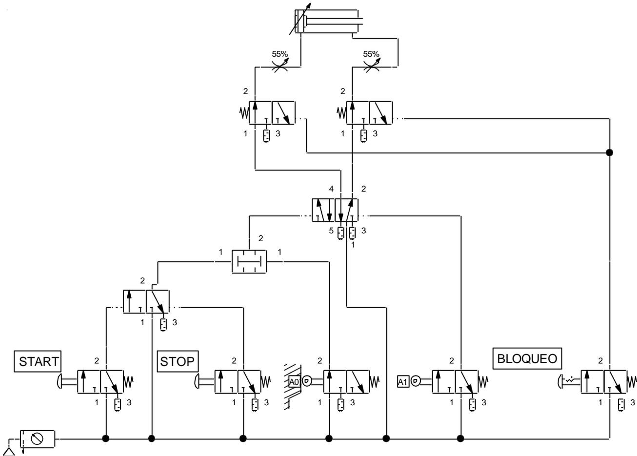
**EXPLICACIÓN:** Al estar el vástago del cilindro a inicio de carrera, se activa el rodillo "A0" y al pulsar el botón "START" el vástago del cilindro inicia su carrera; al llegar a final de carrera se detecta "A1", ésta hace conmutar la
