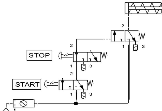
**EXPLICACIÓN:** Al estar el vástago del cilindro en su inicio de carrera, y accionar el botón de "START" pasa la presión a la válvula 3/2 que controla el cilindro porque el botón "STOP" está en una posición de conmutación, que permite el paso del aire, de tal forma que el vástago del cilindro inicie su carrera. Al accionar el botón de "STOP" se corta el pilotaje de la válvula 3/2 y ésta regresa por medio del muelle, haciendo así que el vástago del cilindro vaya a inicio de carrera.
