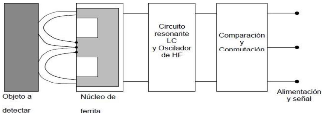
Esquema de funcionamiento de un detector de proximidad inductivo.
