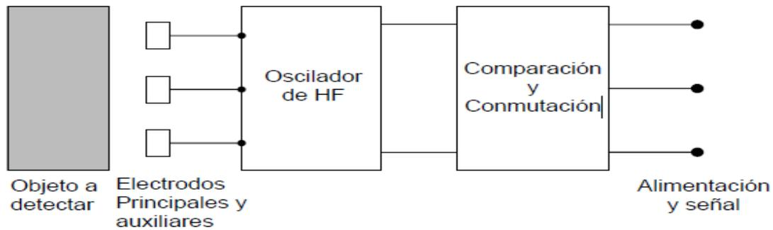
Los detectores capacitivos son influenciados tanto por objetos conductores como por los no conductores. Los metales, dada su alta conductividad, se detectan a grandes distancias. La sensibilidad de estos conductores está muy relacionada con el tipo de material que se va a detectar así como por el grado de humedad ambiental y el contenido en agua del cuerpo.
