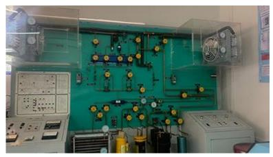
El prestador deberá conocer las características del equipo, además de identificar a la perfección sus componentes mecánicos, eléctricos y tuberías, sus símbolos mostrados en el panel de este y los tableros de control.
