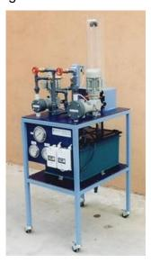
El alumno debe conocer los componentes principales de una bomba de embolo, así como los de una bomba de diafragma, además de proporcionar información básica sobre éstas y sus aplicaciones. El alumno debe conocer el plan de mantenimiento en el equipo grupo prueba bombas alternativas.
