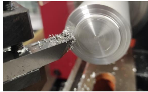
Ilustración 23.- Careo de pieza.
