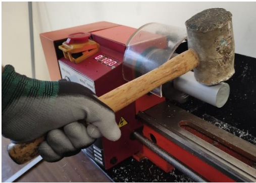
Ilustración 21.- Alineando la pieza.
