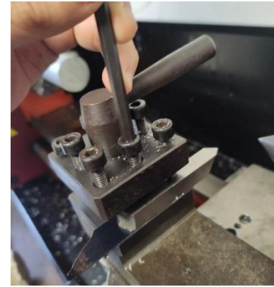
Ilustración 7.- Torre porta herramientas.
