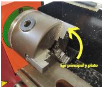
Ilustración 4.- Eje principal y plato.
