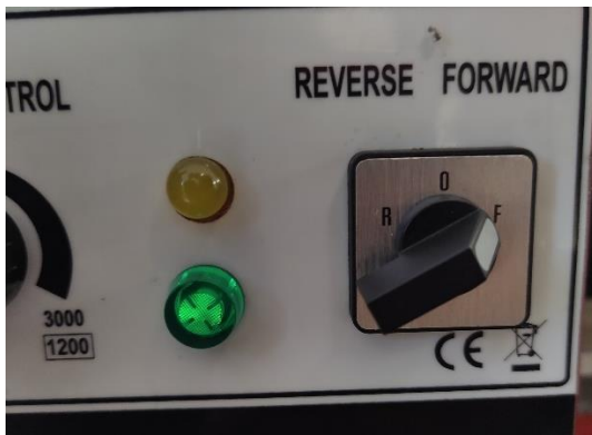
Ilustración 20.- Dirección de giro.
