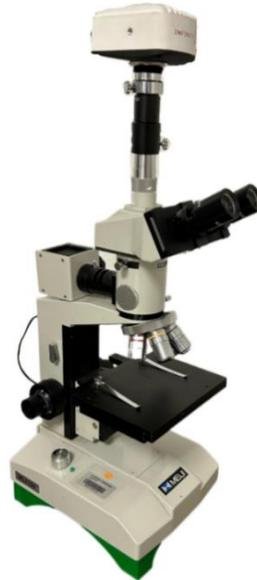
**Ilustración 55.- Microscopio metalográfico.**
