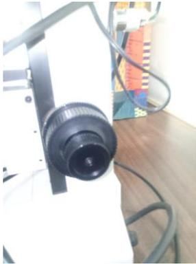
**Ilustración 61.- Macrométrico y micrométrico.**
