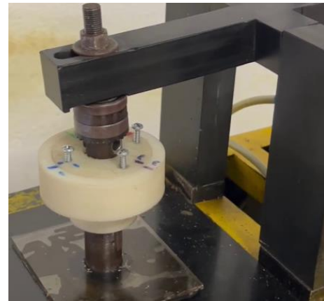
Ilustración 77.- Montaje del disco en el portaprobeta.
