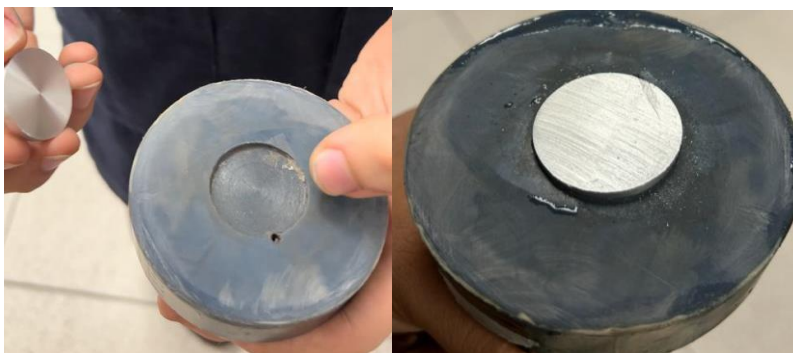
Ilustración 130.- Se coloca la probeta en el portadiscos.
