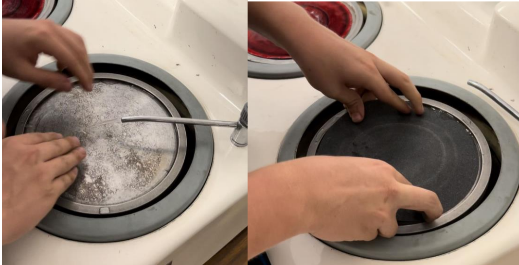
Ilustración 129.- Forma de poner la lija.
