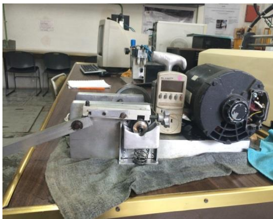
Ilustración 152. Máquina Timken, ensamblada en el Laboratorio de Tribología
