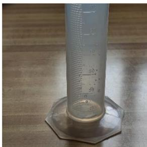
**Ilustración 1.- Probeta.**
