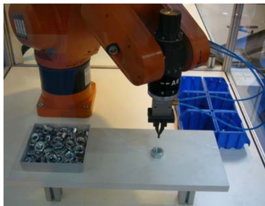
Figura 2.3: Configuración experimental para la toma de tuercas de un contenedor con un brazo robótico (imagen tomada de [25]).
