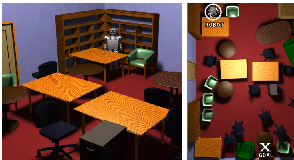
Figura 2.7: Ejemplo de problema NAMO. El robot debe manipular los objetos que le impiden el paso con el objetivo de trasladarse hacia un lugar específico (imagen tomada de [16]).
