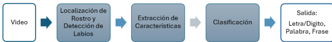
Fig. 3 Estructura general de un sistema ALR
