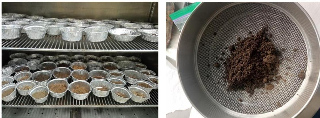
**Figura 20. Secado en estufa y tamizado de muestras.**
