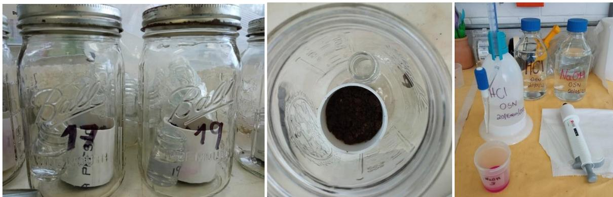
**Figura 24. Frascos herméticos para incubaciones de suelo y de mantillo. Titulación de NaOH,  $\text{BaCl}_2$  y fenolftaleína con HCl 0.5N.**
