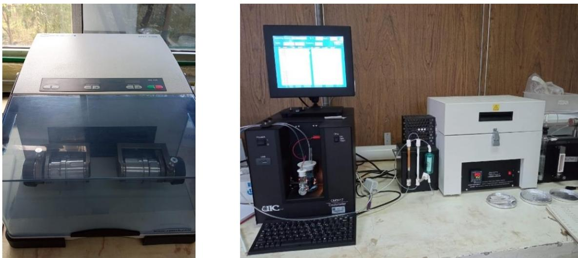
**Figura 22 y 23. Molino mezclador RETSCH MM400 y Coulómetro UIC CM5017**
