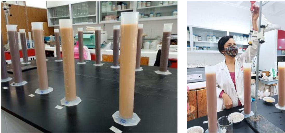
**Figura 19. Determinación textural por método de la pipeta de Robinson.** Sedimentación de fracciones de limo y arcilla y toma de alícuota
