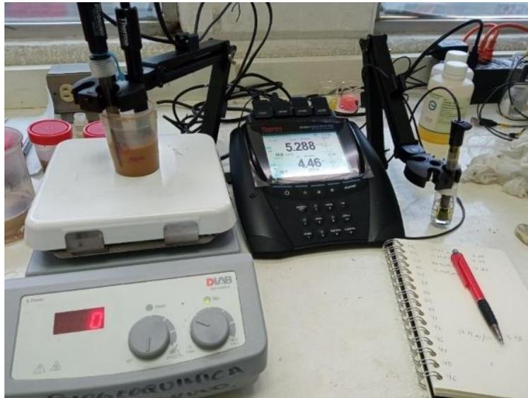
**Figura 21. Potenciómetro Thermo Scientific Orion Versa Star para medición de pH y conductividad eléctrica.**
