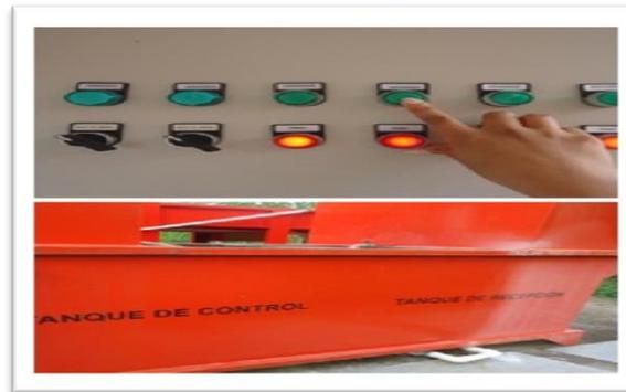
8. Cuando el agua comience a pasar al tanque de control abrir la válvula de floculante y dejar pasar 9L/min. Figura 8
