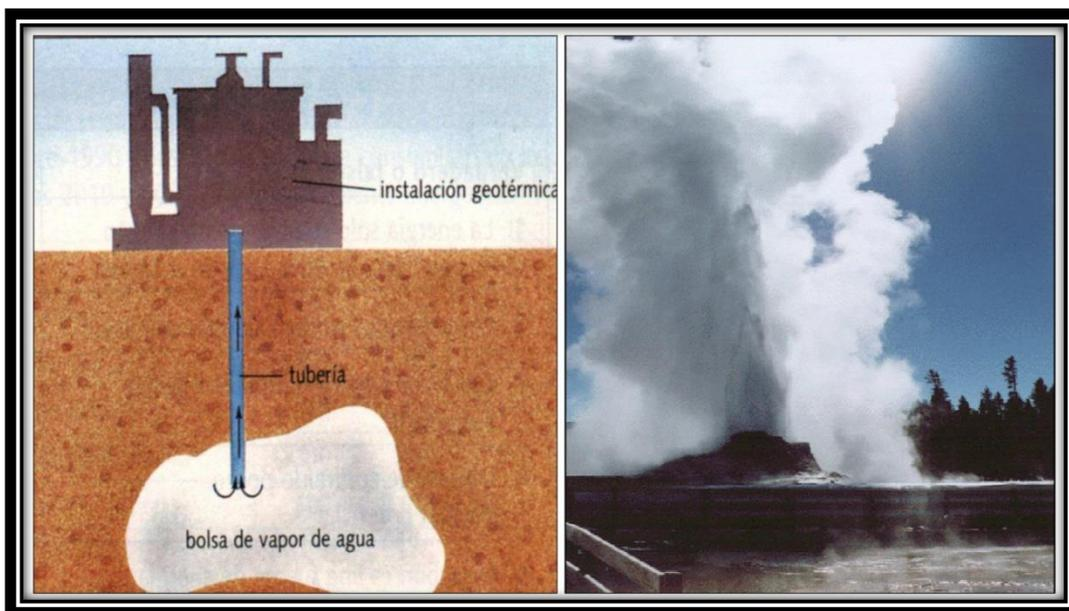
Ilustración 2.3-1 Extracción de vapor para la rotación de una turbina. (Fuente: González, 2009).
