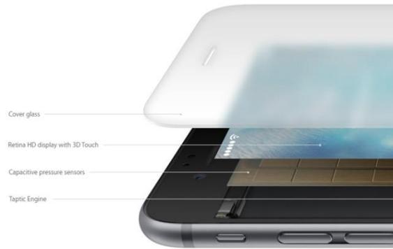
Figura 4 Capas utilizadas para habilitar “3D Touch” en iPhone 6S [21].
