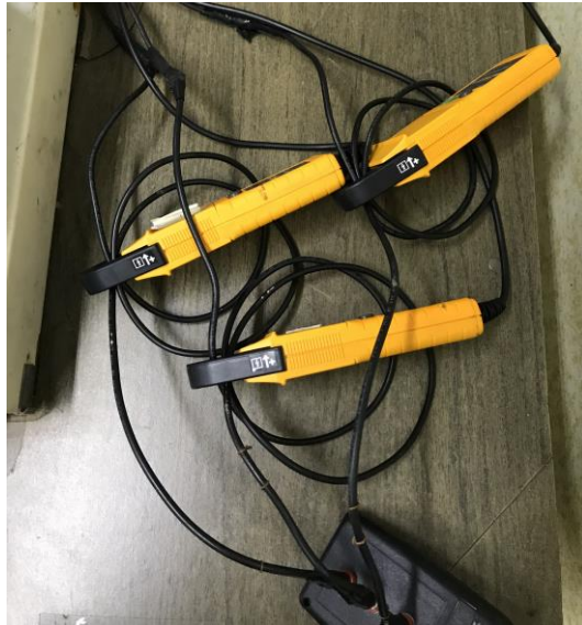
Figura 15 Pinzas Fluke en posición 1, 2 y 3, correspondientes a cada línea de alimentación
