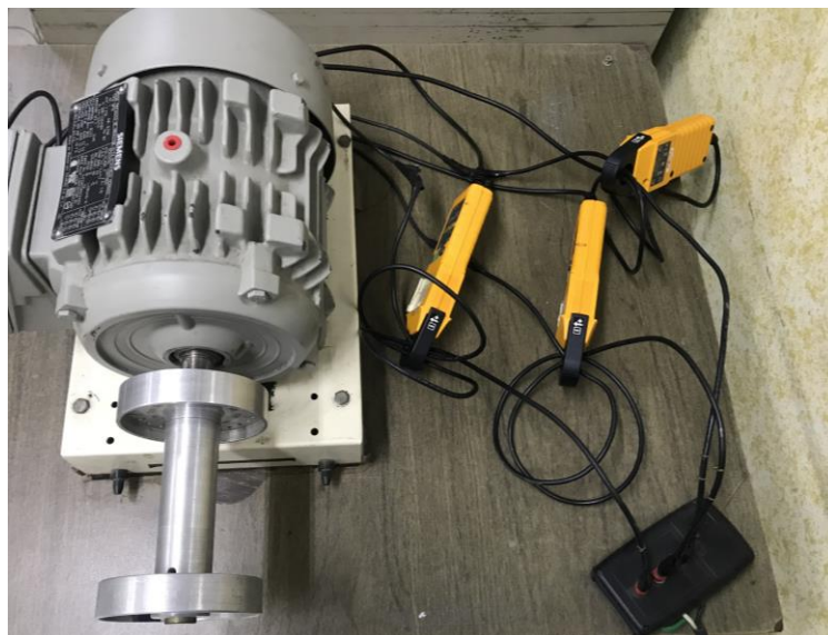
Figura 14 Conexión de fases y pinzas Fluke
