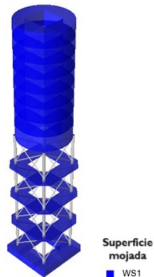
Figura 3.3 Superficie mojada del modelo de la plataforma Spar.
