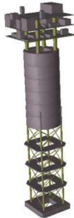
Figura 3.1 Modelo de la plataforma Spar armadura
