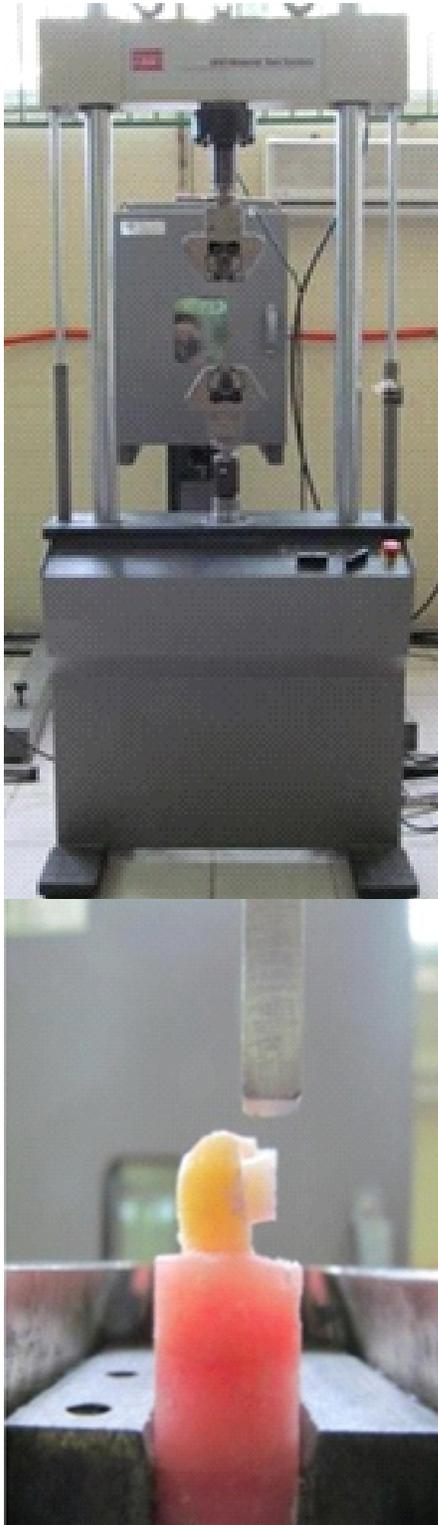
Figura 3. Colocación de los especímenes en la Máquina de ensayos universal MTS 810
