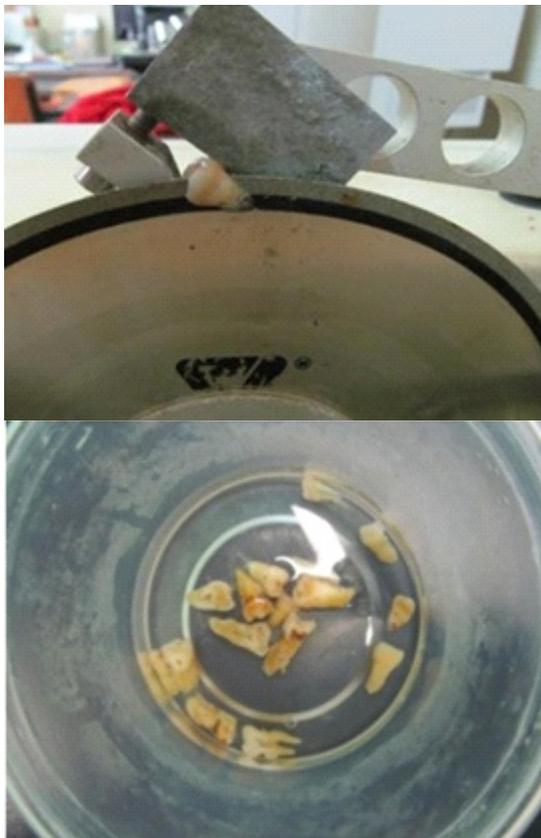
Figura 1. Seccionado de molares en sentido longitudinal.
